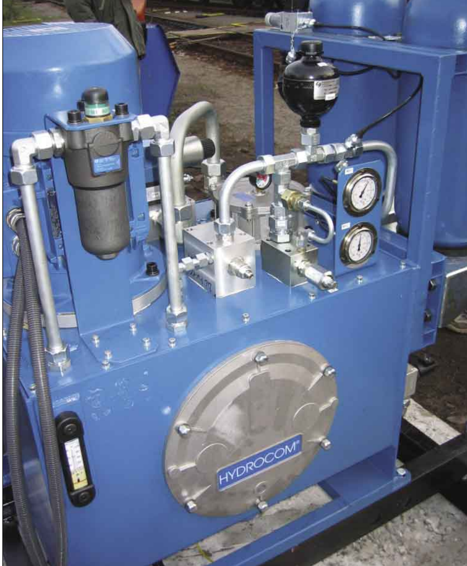
Detail na hydraulický agregát, použitelný pro napájení dvou kolejových brzd.
