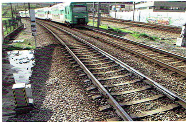
Příklad instalace kolejnicového mazníku CL-E1 s kabelovým napájením
